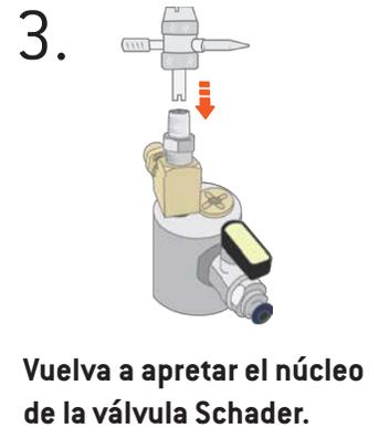
Vuelva a apretar el núcleo de la válvula Schader.
