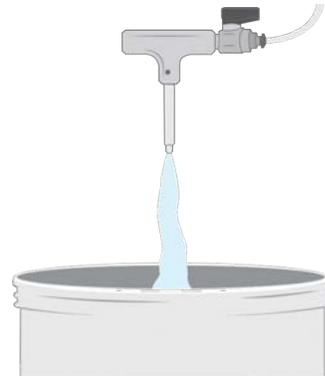
Una a la vez, abra las válvulas de inyección de la T sobre un recipiente de recolección de enjuague (como un balde con tapa o una botella de inyección vacía) para permitir que la solución de limpieza fluya a través de cada punta.
