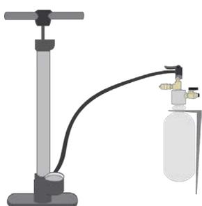
Conecte la bomba de bicicleta a la válvula Schader de la tapa de la botella.
