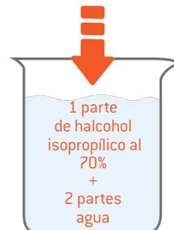
Limpie a fondo el conector del arnés, la válvula de alivio de presión y otros componentes según sea necesario. Se recomienda quitar y remojar el conector del arnés en la solución de limpieza después de un uso intensivo.
